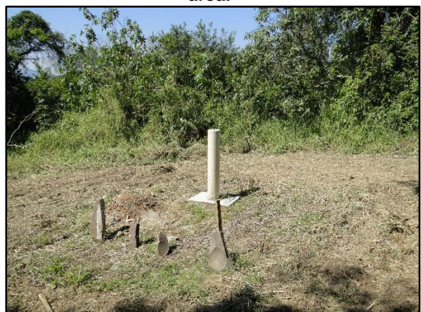
Figura 12-28. Marco geodésico instalado na área.
