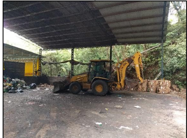
Figura 12-11. Retroescavadeira que direciona os recicláveis para a esteira.
