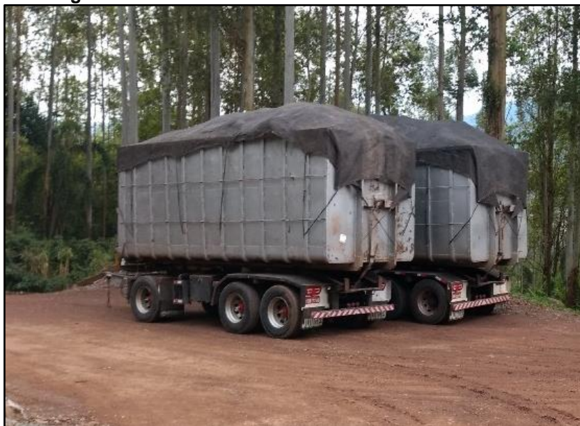
Figura 12-16. Contêineres de 37 m 3 cobertos com lona.
