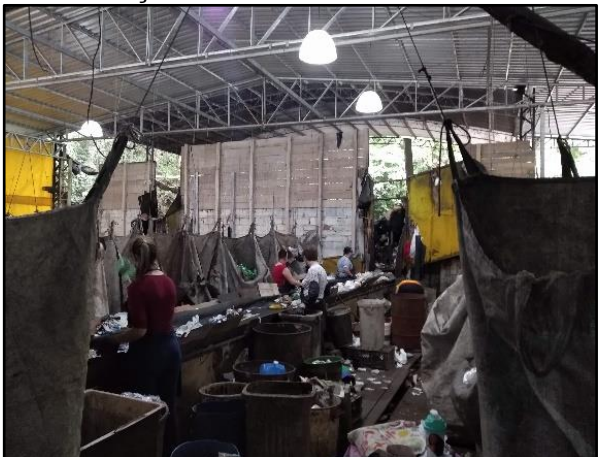
Figura 12-12. Esteira onde ocorre a triagem e seleção dos materiais recicláveis.
